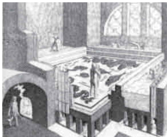
Figura 3.2: Reconstrucció ideal d'un caldarium amb el sistema d'escalfament subterrani ( hipocaustum ).
